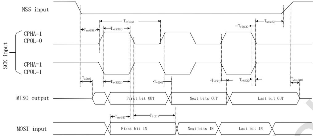
图 5-4 SPI 时序图 – 从机模式, CPHA = 1
