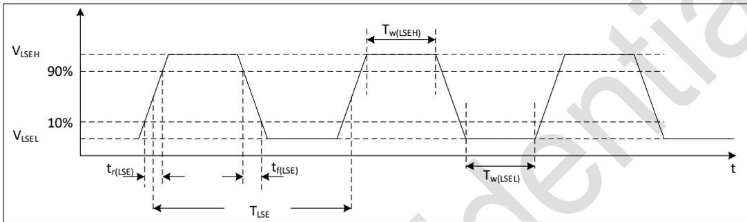
图 5-2 外部低速时钟时序图
